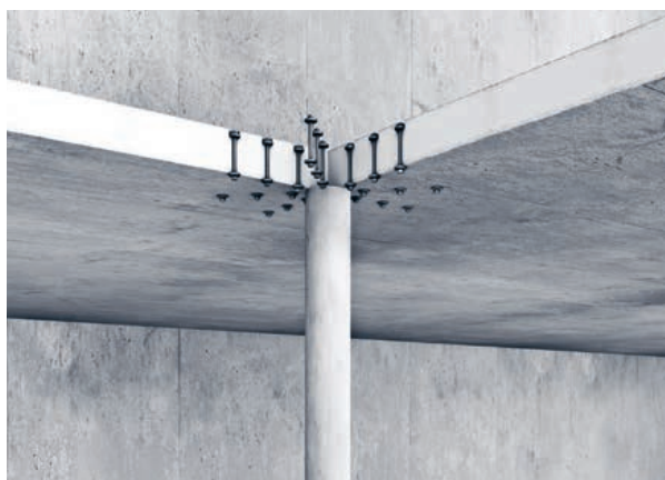
RINO Bar: Anordnung im Querschnitt
