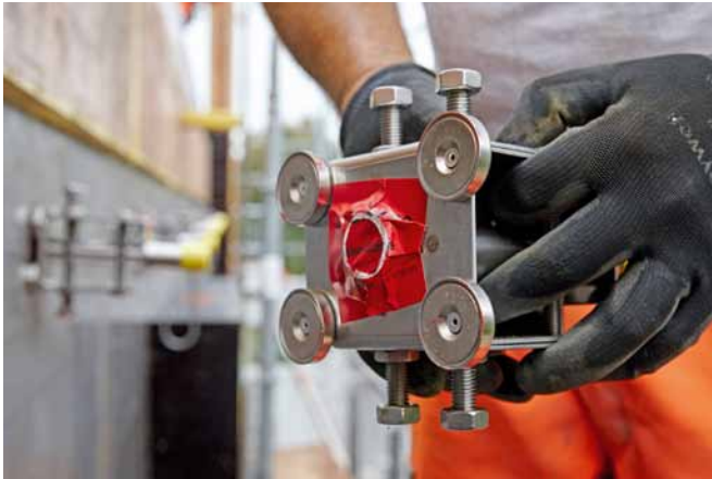
Die Bewehrungselemente ARBO, CRET und RIBA sind mit je vier Hochleistungsmagneten ausgerüstet.
